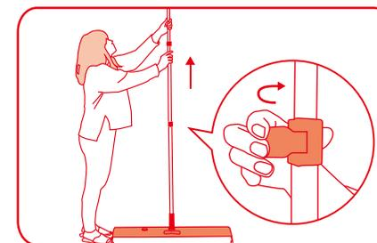
③支柱パーツをタンクの穴に挿し込み、支柱を最大まで伸ばし、固定します。
