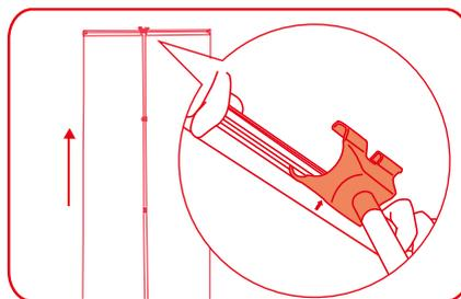
④本体から盤面を引き上げて支柱上部に取り付けます。※その際、矢印のマークが真ん中にくるように取り付けます。
