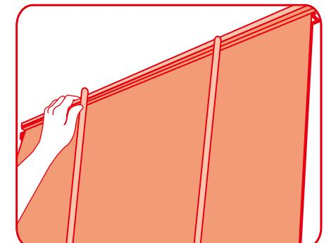
⑥盤面上部のフック部分に、支柱を引っ掛け
