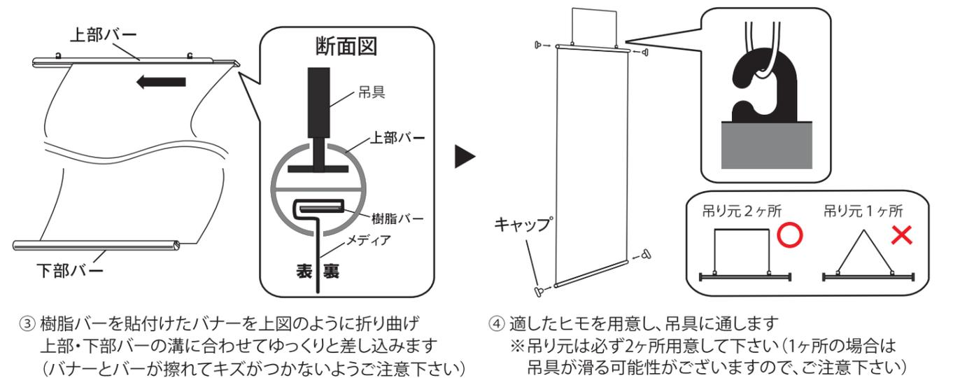
※製品の仕様上、キャップが上部バー・下部バーよりも太い為、設置場所によっては壁面にキャップが干渉する場合がございますので、吊り元の位置を調整するなど、ロケーションに合わせて適宜対策を講じて下さい
